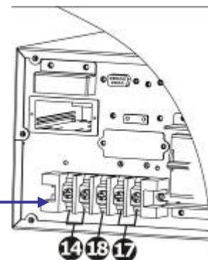
Figura 4: Terminales de Entrada/Salida para rack panel II
